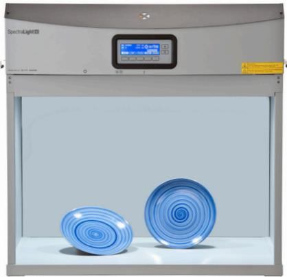
SpectraLight QC 所采用的照明技术优于市场上的任何光源箱。由于本仪器具有的光源数量较多 — 包括日光、白炽光“A”、水平日光、三种荧光（CWF、U30、U35、TL83 和 TL84 之间的任何组合）和 UVa，数量超过任何其他产品，因而可以应用于任何规格。集成光传感器提供荧光灯照度的实时数字输出，并可以通过操作员设置以满足行业标准，如 ASTM 和 AATCC。仪器的闭环荧光灯控制使得操作员可以从一个光源移动到下一个光源，而无需等待需要的预热时间。相同的传感器和电子产品，确保实时控制所有的荧光灯，保持灯泡整个使用期间的精确照度。SpectraLight QC 还提供出厂校准的紫外线，使用户能够根据样品需求（基于应用）调整紫外线量。
